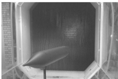
شکل 6 نحوه قرار گیری مدل زیرسطحی در اتاق آزمون تونل باد برای انجام آزمایش‌های مرئی‌سازی با روغن
