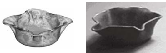
شکل ۸ مقایسه چروکیدگی ورق در کار آزمایشگاهی (راست) [۱۵] و شبیه‌سازی (چپ)
