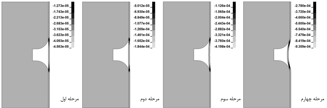
شکل 6 مقدار جابه‌جایی شبیه‌سازی (متر) با ولتاژ 4300 ولت در چهار مرحله مختلف
