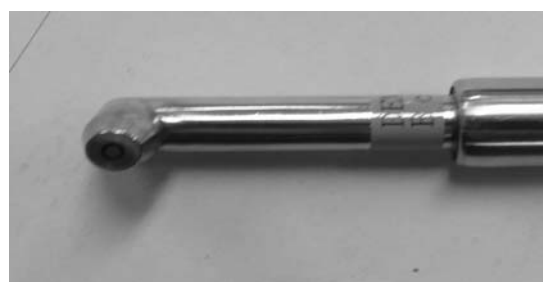
شکل ۳ پروب خازنی مورد استفاده در اندازه‌گیری (ساخت شرکت ژاپنی ADE Micro Sense)
