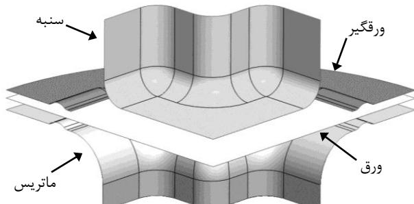
شکل ۳ مدل اجزا محدود فنجان صلیبی شکل
