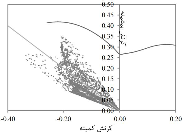
شکل ۹ نمودار حد شکل دهی قطعه صلیبی شکل
