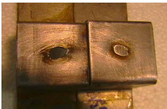
شکل ۵ نحوه ایجاد زوال در دو ورق با ضخامت‌های ۱ و ۱/۵ میلیمتر هیچگونه ترکی مشاهده نمی‌گردد
