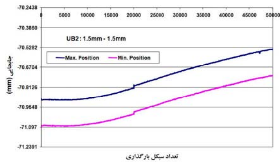
شکل ۲۳ نمودار جابه‌جایی - تعداد دوره بارگذاری برای نمونه UB1۵-۱۵-۲، P_{max}=650N (شروع انتشار ترک تقریباً در ۸۰۰۰ سیکل)
