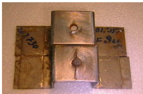
شکل ۴ نحوه رشد ترک در ورقهای با ضخامت ۱/۵ میلیمتر
