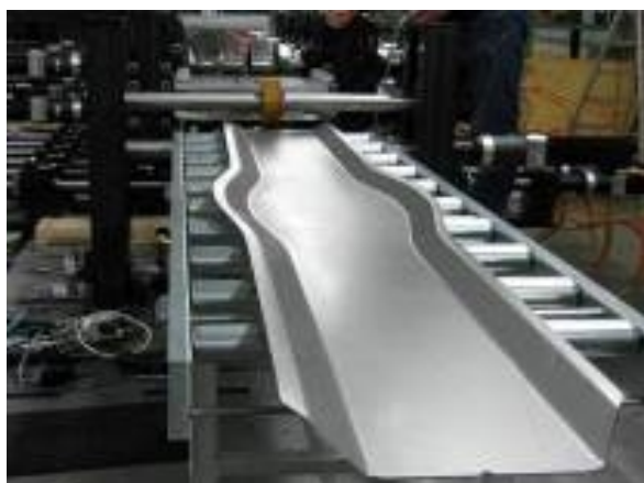
شکل ۳ یک نمونه پروفیل کلاهی با سطح مقطع متغیر تولید شده در فرآیند
