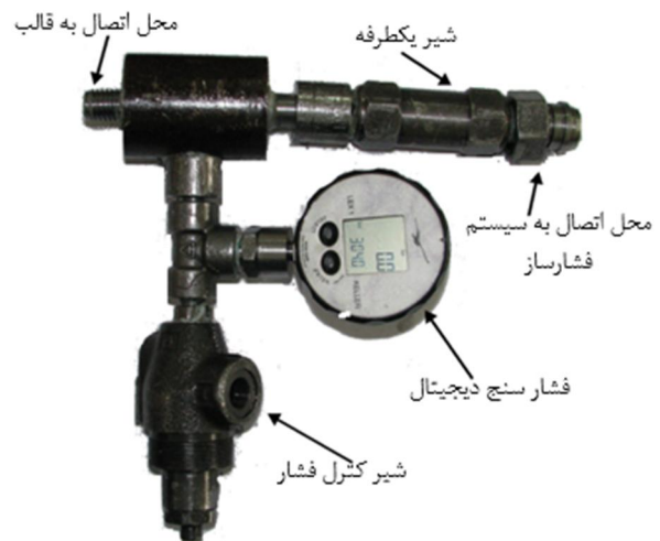
شکل 7 تجهیزات سیستم هیدرولیک کنترل فشار
