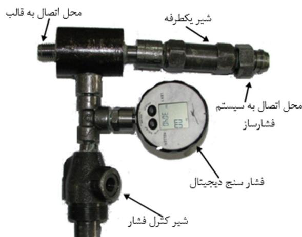
شکل 7 تجهیزات سیستم هیدرولیکی کنترل فشار
