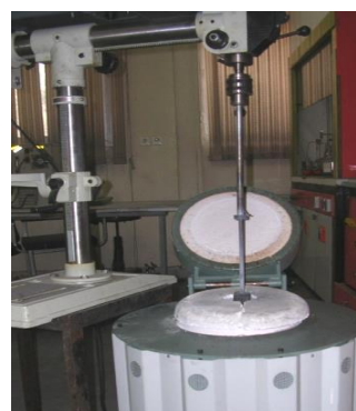
شکل ۱ شمایی از کوره دوبریزی
