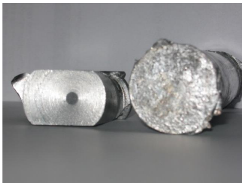
شکل ۲ شمایی از قطعه کامپوزیتی قبل و بعد از عملیات نورد
