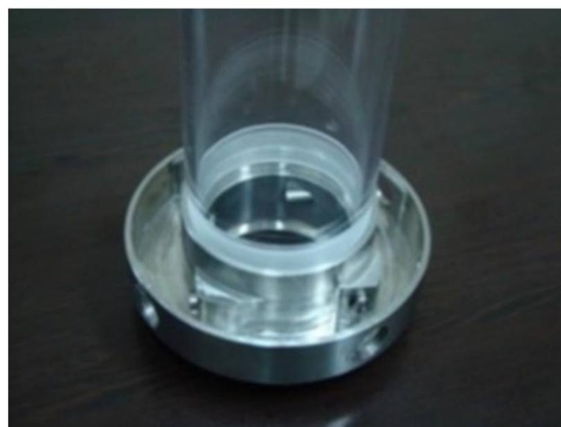
شکل 4 شمایی از طرح محفظه به منظور تست سرد 1 و 7- کالکتور سیال؛ 2- محفظه پلکسی گلس؛ 3- انژکتور مماسی؛ 4- پله‌ی تکیه‌گاهی؛ 5- منفذ ورودی جهت تعویض انژکتورها؛ 6- ورودی سیال
