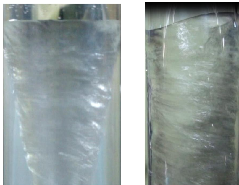
شکل 12 تاثیر قطر محفظه بر یکنواختی جریان گردابه‌ای
