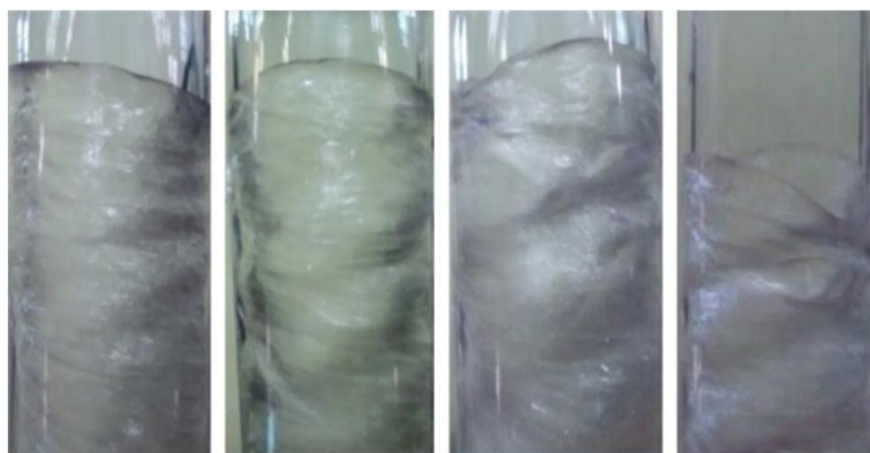
شکل 11 تاثیر تعداد انژکتورهای مماسی بر یکنواختی جریان گردابه‌ای در محفظه با قطر 70 میلی‌متر
