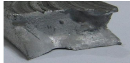
شکل 15 سطح مقطع شکست نمونه 5
