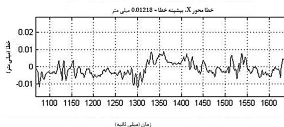
شکل ۵ خطا حرکت در سه محور مسیر منحنی ایرفوایل NACA0025 سه بعدی
