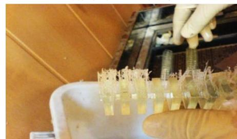
شکل 7 جدا کردن تکیه گاه از قطعه کار
