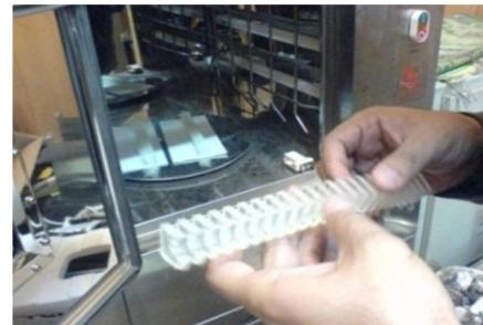
شکل 8 قرار دادن نمونه‌ها در حمام اتراسونیک جهت پخت نهایی
