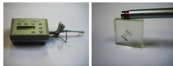
شکل 15 دستگاه زیری سنج هنگام اندازه‌گیری زیری سطح
