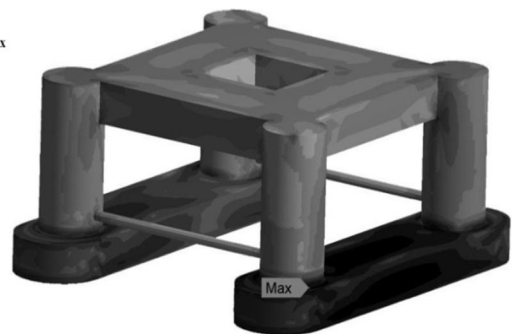
شکل 7 نمایی از توزیع تنش فون مایرز در کل سکوی حفاری نیمه‌شناور امیرکبیر
