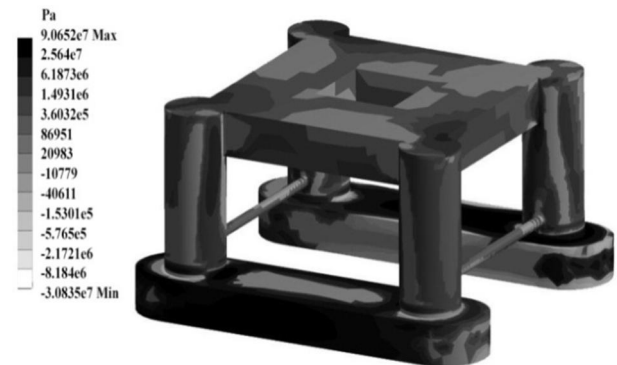
شکل 11 نمایی از حداقل توزیع تنش اصلی بیشینه ایجاد شده در سکوی امیرکبیر در یک دوره تناوب موج
