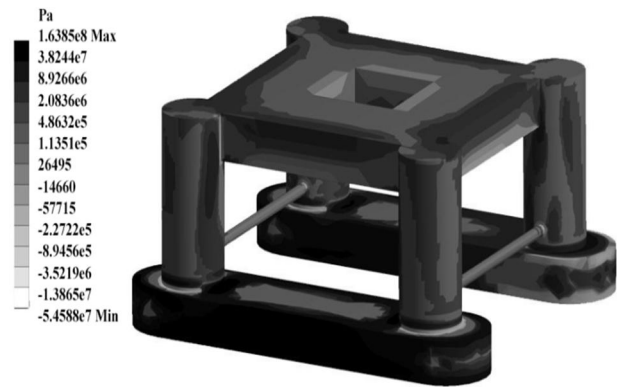
شکل 10 نمایی از حداکثر توزیع تنش اصلی بیشینه ایجاد شده در سکوی امیرکبیر در یک دوره تناوب موج
