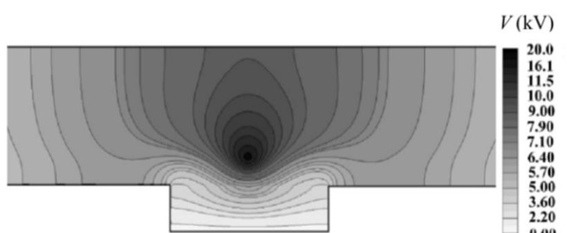
**شکل 6** توزیع پتانسیل الکتریکی در ولتاژ اعمالی 20 کیلو ولت
