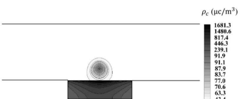
**شکل 7** توزیع چگالی بار الکتریکی در ولتاژ اعمالی 20 کیلو ولت
