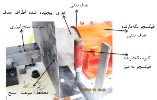
شکل ۵ قرارگیری هدف بتنی در فیکسچر، توری پیچی و گیره ثابت کننده فیکسچر
