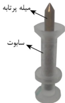
ج- نمونه پرتابه میله بلند به همراه سابوت
