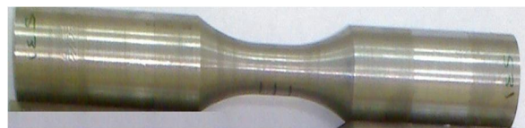
شکل 1 نمونه‌ی استفاده شده در آزمایش چرخه‌ای با نرخ کرنش پایین
