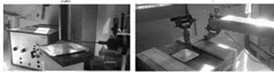
شکل ۱۷ اندازه‌گیری چگالی شار مغناطیسی (الف) همگی قطعات غیر فرومغناطیس (ب) فیکسچر قطعه‌کار و آهن‌ریا فرومغناطیس، قطعه‌کار غیر فرومغناطیس
