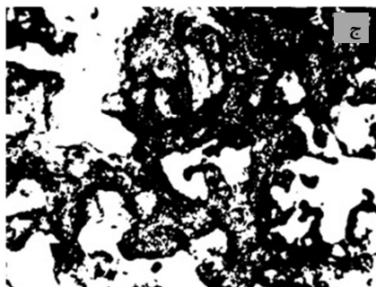
شکل ۶ پردازش تصویر، الف) تصویر اصلی گرفته شده توسط دوربین، ب) تصویر سطح چرخ سنگ پس از ۶۰ دقیقه نوپزینگ، ج) تصویر باینری شده توسط نرم افزار متلب، (سنگ زنی با روان کاری کمینه گاز آرگون، عمق درسینگ: ۱۵ میکرون و سرعت پیشروی درس: ۰.۰۰۰۰۰۰ میلیمتر بر دقیقه).
