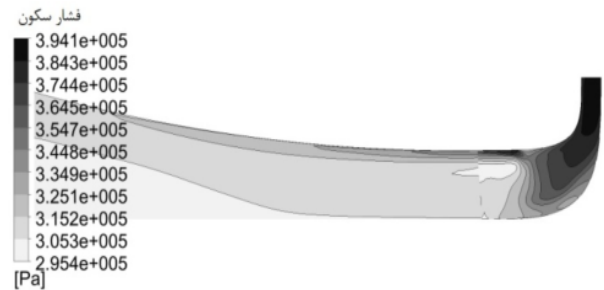
شکل ۱۶ نمای نصف‌النه‌ای فشار سکون در روتور و دیفیوزر توربین
