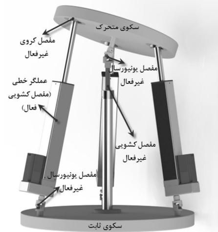
(الف) اجزا تشکیل دهنده و چیزمان در ساختار ربات
