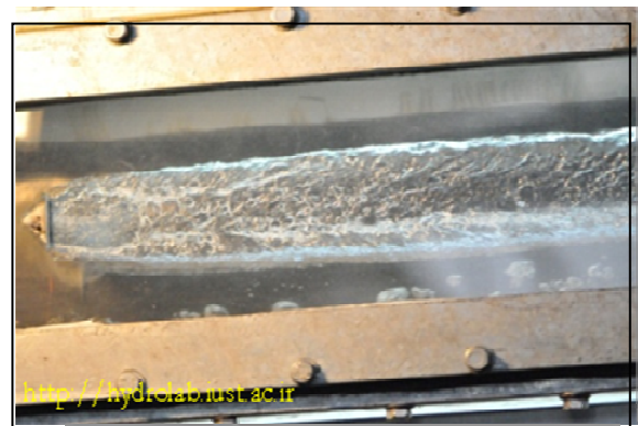
شکل ۱ سوپر کاویتاسیون ایجاد شده پشت دماغه، در تونل آب آزمایشگاه هیدرودینامیک دانشگاه علم و صنعت ایران [۲]
