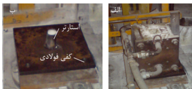
شکل ۳ ساختمان محفظه ذوب الف- قالب مسی آب سرد ب- کفی فولادی به همراه استارتر
