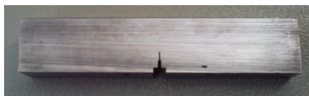
شکل ۹ نمونه ساخته شده برای اندازه‌گیری J_{Ic}
