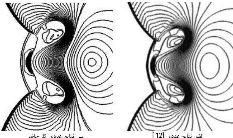
شکل 8 کانتور توزیع فشار اندر کنش شاک و حیاب هوا در آب. مقایسه کیفی نتایج عددی کار حاضر با نتایج عددی [12]
