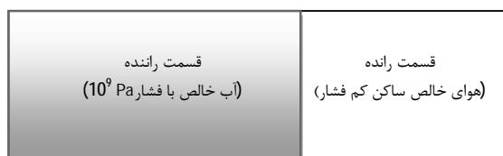
شکل 2 طرحواره مسئله لوله ضربه دو فازی مایع-گاز
