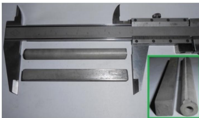
شکل 1 بیلت‌های با مقطع دایروی و مربعی از جنس تیتانیوم خالص تجاری BT1-0
