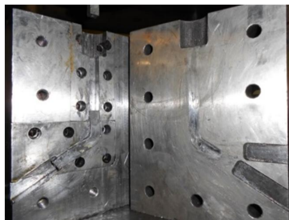
شکل 3 قالب ECAP مورد استفاده با ابعاد کانال 10 \times 10 \text{ mm}^2 و زاویه کانال و گوشه 120 و 20 درجه
