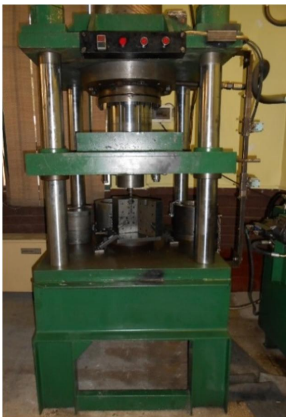
شکل 4 پرس هیدرولیک 200 تن مورد استفاده
