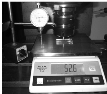
شکل ۶ تجهیزات آزمایشگاهی میکرو خراش
