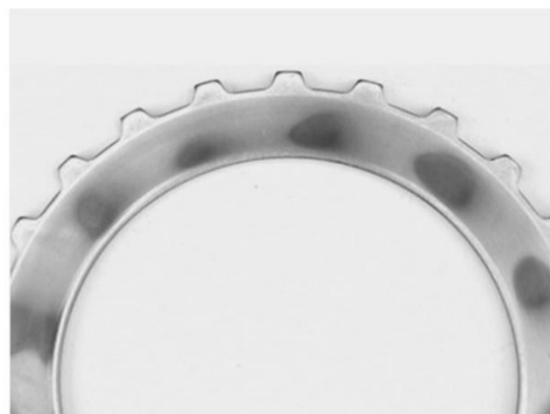
شکل 1 تصویری از مناطق داغ‌دیده پس از تنها یک بار درگیری کلاچ [2]
