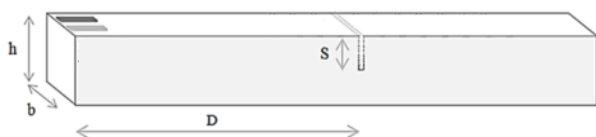
شکل ۱ شمای کلی تیر ضخیم مورد بررسی شامل یک ترک نمونه
