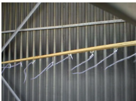
شکل ۱۴ الگوی جریان هوا در محل ۴ دلتای مناسب
