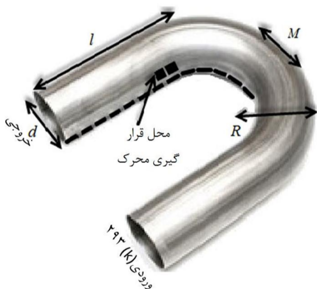
شکل 10 هندسه‌ی لوله‌ی U شکل
