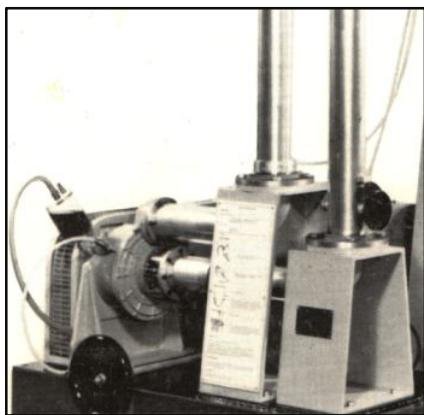
شکل ۱ نمایی از تست ریگ کمپرسور گریز از مرکز آزمایشگاه آبرودینامیک دانشگاه علم و صنعت ایران
