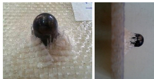
شکل ۱۰ نفوذ پرتابه با دماغه نیم‌کروی در هدف کامپوزیتی (آزمایش H-5)
