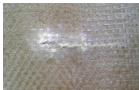
شکل ۱۵ اثر کشیده شدن تیزی پرتابه بر لایه‌های جلویی هدف بر اثر انحراف پرتابه قبل از ورود به هدف (آزمایش C-7)
