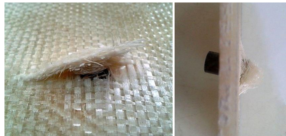
شکل ۸ نفوذ پرتابه با دماغه تخت در هدف کامپوزیتی (آزمایش B-2)
