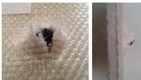
شکل ۱۲ نفوذ پرتابه با دماغه مخروطی 90^\circ در هدف کامپوزیتی (آزمایش Ot-3)
