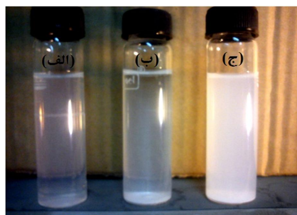
شکل 16 عکس سوسپانسیون‌های (الف) حاوی نانوذرات، (ب) حاوی میکروذرات و (ج) حاوی مخلوط میکروذرات و نانوذرات
