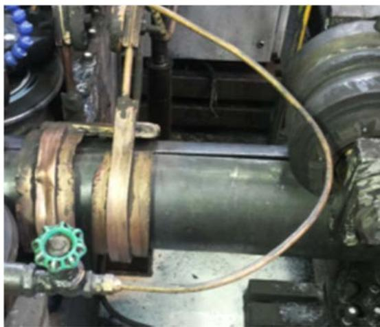
شکل 3 نمایی از ناحیه وی شکل و ایندکتور از نمای بالا.
