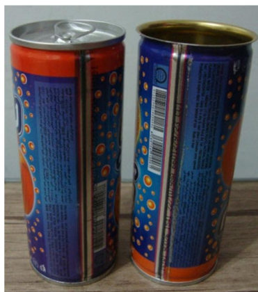
شکل 1 نمونه‌ی دارای دو سرپوش (چپ) و نمونه‌ی تک سرپوش
