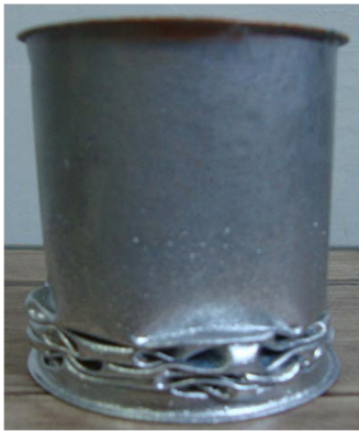
شکل 7 شکل چین‌خوردگی پایینی لوله
