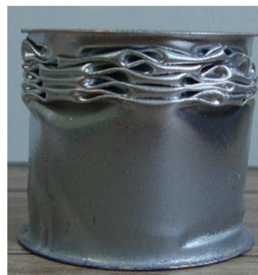
شکل 6 شکل چین‌خوردگی بالایی لوله
