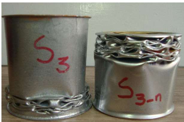
شکل 10 جاذب S_{3-n} بعد از آزمایش ضربه در کنار جاذب S_3
