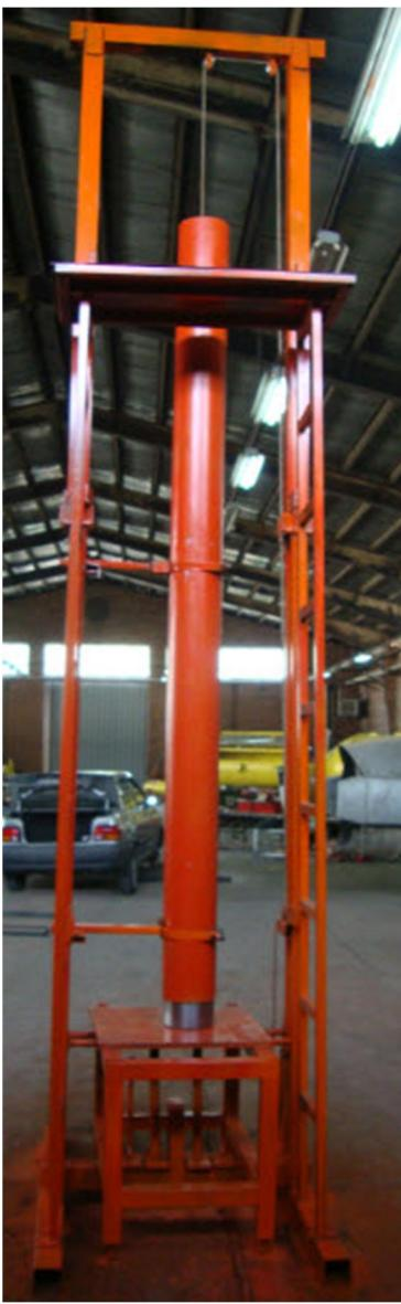
شکل 4 نمای کلی دستگاه ضربهزن سقوط آزاد
