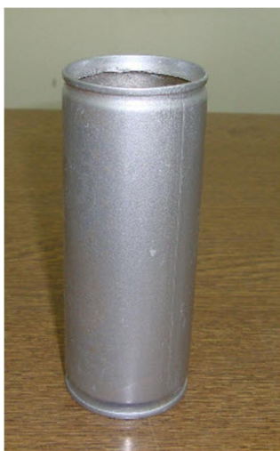
شکل 2 نمای جاذب لوله‌ای با برش دایره‌ای روی سرپوش
