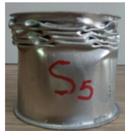
شکل ۱۱ نمای جاذب S<sub>5</sub> بعد از آزمایش ضربه
