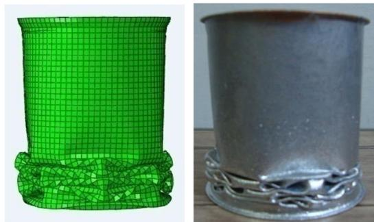
شکل ۱۴ چین خوردگی انتهایی جاذب لوله‌ای در آزمایش تجربی و شبیه‌سازی
