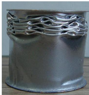
شکل 6 شکل چین خوردگی بالایی لوله
