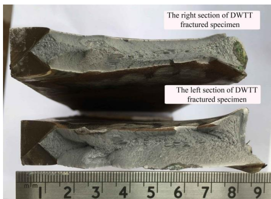
Fig. 9 Fracture surface of DWTT specimen with spiral seam weld شکل 9 سطح شکست نمونه آزمایش ضربه سقوطی حاوی درزجوش ماریچ
