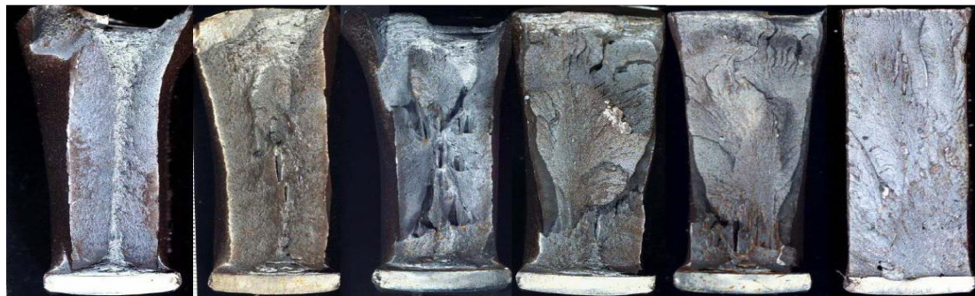
Fig. 10 Fracture surfaces of DWTT specimen (base metal of API X65 and wall thickness is 23.4 mm) [15] شکل 10 سطح شکست چند نمونه آزمایش ضربه سقوطی (با شیار پرسی) با ضخامت 23.4 میلی‌متر از جنس فولاد پایه API X65 [15]
