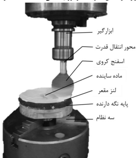
شکل 10 فرایند پرداخت با ابزار کروی
