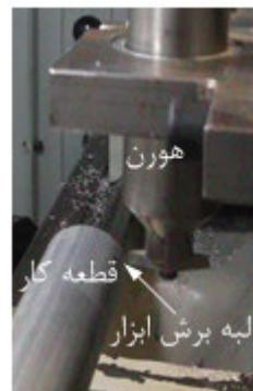
شکل ۴ مجموعه ابزار گیر سیستم ارتعاشی
