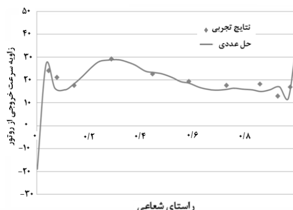
شکل ۱۱ مقایسه نتایج تجربی و محاسبه شده تغییرات زاویه سرعت خروجی از روتور در راستای شعاعی
