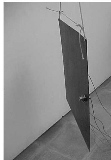
شکل 10 صفحه فلزی تحت آزمایش مودال محیطی به همراه جرم اضافی
