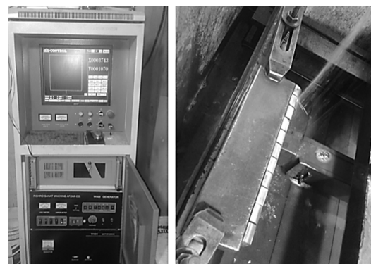
شکل ۱ نمایی از دستگاه برش کاری تخلیه الکتریکی سیمی و نمونه‌های برش-کاری شده
