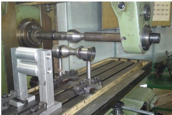
شکل ۶ دستگاه شکل‌دهی غلتکی سرد با نیروی محرکه ماشین فرز
