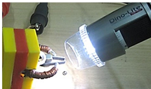
شکل 14 اندازه گیری میکروسکوپی زاویه انحنای تیرهای فک گریپر مینیاتوری
