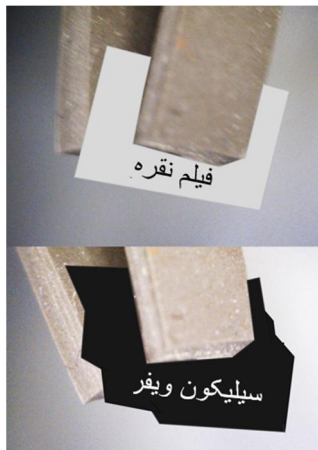
شکل 12 تصویر میکروسکوپی فک‌های گریپر حین برداشت و نگه داشت ویفر سیلیکون و فیلم نقره
