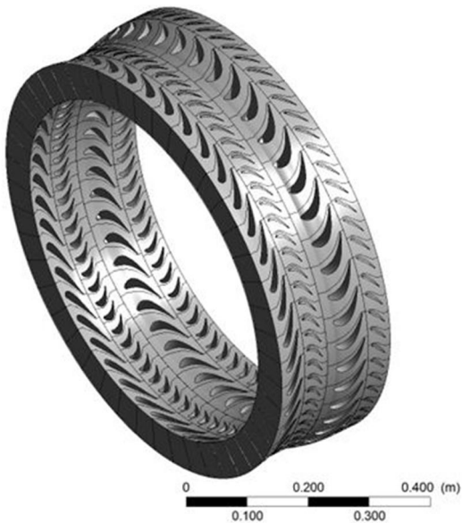
شکل 2 هندسه‌ی سه بعدی توربین
