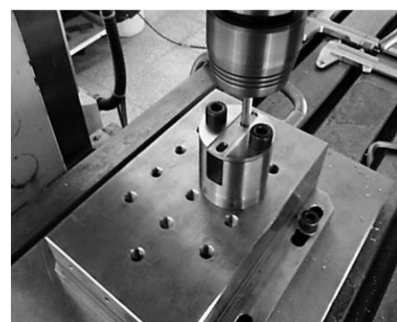
شکل 5 تصویر نمونه گیره‌بندی شده روی دینامومتر
