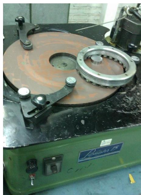
شکل ۱ دستگاه لپن کاری 15 LAPMASTER
